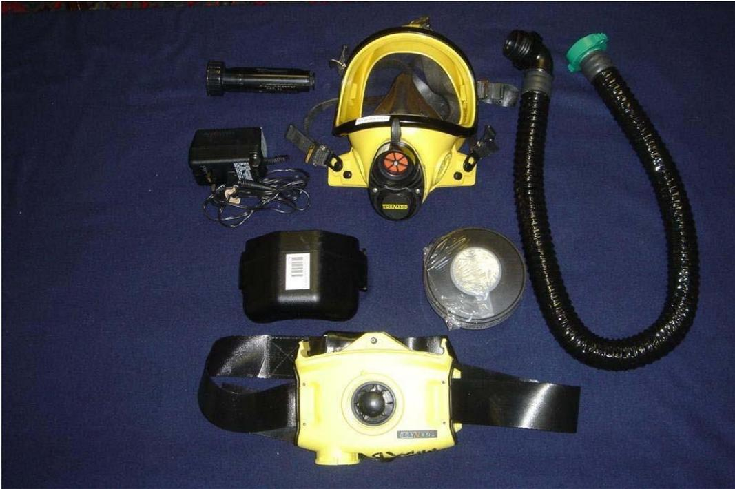
Figura 16. Equipamento de protecção respiratória
